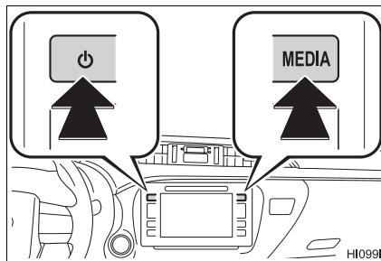
Güç düğmesi: Müzik sistemini açmak ve kapatmak için bu düğmeye basın. Sistem kullanılan en son modda açılır.
